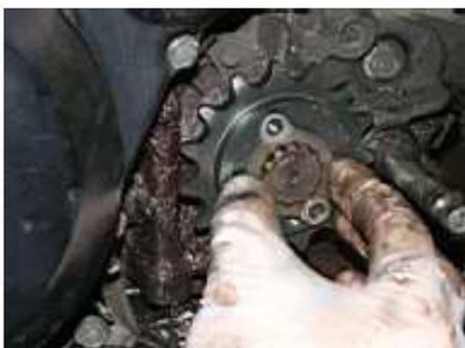
Successivamente monta il ferma pignone inseriscilo e ruotalo nel suo spacco fin che i fori non combaciano. Metti un filino di frenafreccette medio sulle due viti, serrale bene ma senza forzare troppo (sono di piccole dimensioni). Una volta quando i frenafreccette era roba da ricchi usavano qualche goccia di vernice sintetica.
