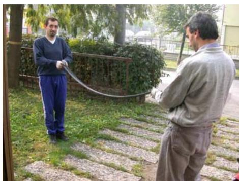
Per rimuovere le eventuali maglie in più se non si dispone dell'attrezzo specifico (lo stesso che poi ci permetterà di montare e ribattere la maglia di chiusura) bisogna molare la testa di uno dei perni con un flessibile e picchiare energicamente il perno con un sottile punteruolo appoggiando il lato della catena dal quale dovrà fuoriuscire il perno su una base cava (un bullone va benissimo).
