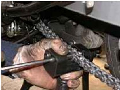
Attrezzando adeguatamente lo strumento andiamo a ribattere la parte terminale dei perni, quella in rame.
