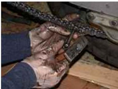
Una volta montata la maglia passiamo a fissarla ribattendo la parte terminale in rame dei due perni. Con il punteruolo andremo a svasarli. Bastano una decina di colpi nemmeno tanto forti per deformare la parte in rame e impedire alla chiusura di scendere.
