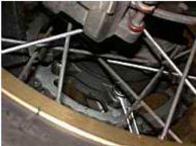
Allenta le viti della corona con la marcia inserita. Per fare questo ti serve la chiave del 14 e la brugola del 6 (+ se necessario un tubo per fare maggiore leva). Se non hai una chiave adatta e di buona qualità o ti accorgi di fare molta fatica, prima di rovinare le viti fermati ed aspetta di aver rimosso la ruota e messo la corona in morsa (descritto in seguito).
