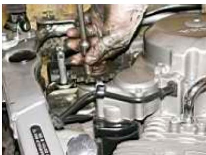
Smontiamo la leva del cambio (una vite del 10) e rimuoviamo il carterino con delle viti dell'8 e successivamente le due viti del pignone del 10 e la placchetta fermapignone.
